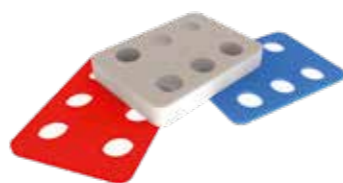
CALES D'ASSISE EN PVC Prévoir 2 cales par panneau, épaisseur de 2 à 20 mm dépend du niveau du dallage.
